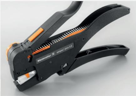
Unsere stripax® plus 2.5 vereint drei Funktionen in einem Werkzeug, sodass Sie mit einem Werkzeug Kabel schneiden, abisolieren und crimpen können. Mit unserem Multitalent verarbeiten Sie verkettete Aderendhülsenstreifen mit Querschnitten von 0,5 bis 2,5 mm<sup>2</sup> (AWG 20 bis 14).
