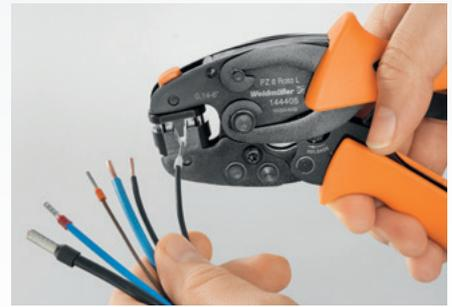
Unsere PZ 6 Roto L besticht durch ihr drehbares Gesenk, mit dem Sie das Werkzeug ganz einfach Ihrer Arbeitsumgebung anpassen. Die Arretierung sorgt für Sicherheit und Stabilität bei jedem Crimp und macht die PZ 6 Roto L zum Star in jeder Rolle.
